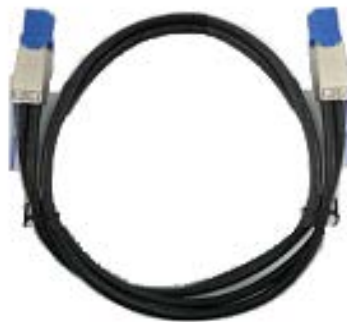
图4-36 安装防尘盖的 SAS 线缆示意图
